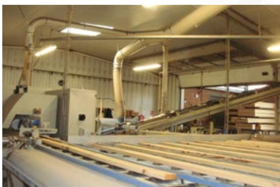
D'une qualité sans noeud, les bois sont assemblés grâce à une colle vnylique D3 ou avec un rajout d'un durcisseur pour obtenir un collage D4 avant une finition (verni, lasure, peinture, saturateur, ...).
